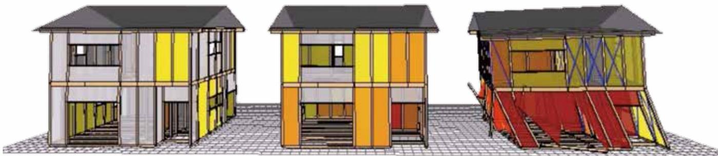
工法別倒壊シミュレーション
