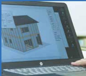
ウォールスタットにて建築時のシミュレーションデータを基に、防災科学技術研究所が観測した地震データを利用し建物の揺れを再現します。
